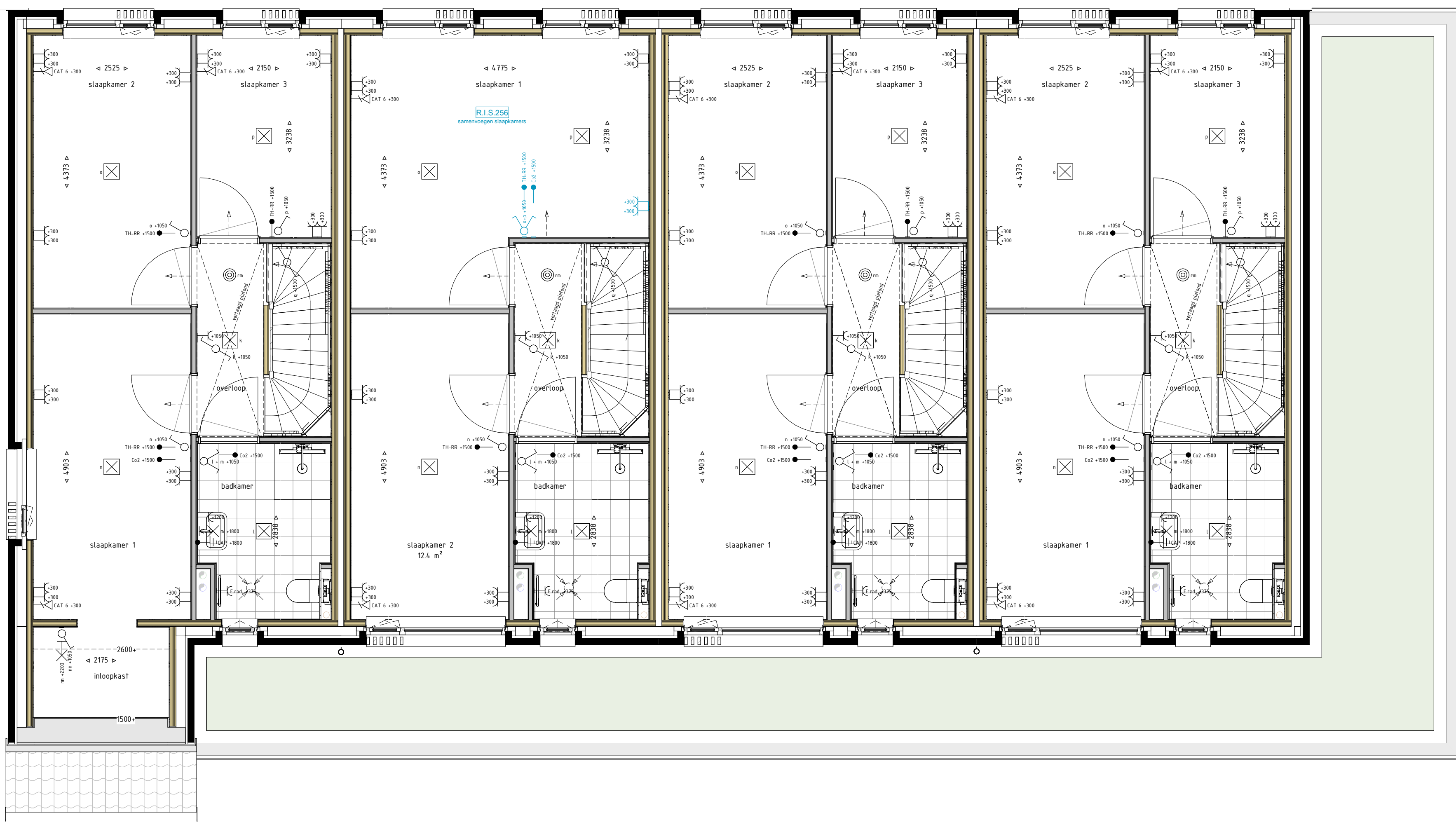
Eerste verdieping - samenvloegen slaapkamers 1:50
